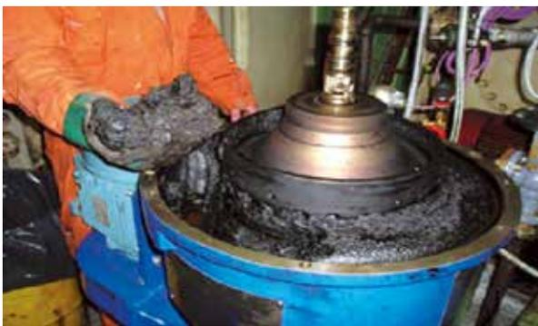
図13. 不安定な燃料油を処理した分離機
