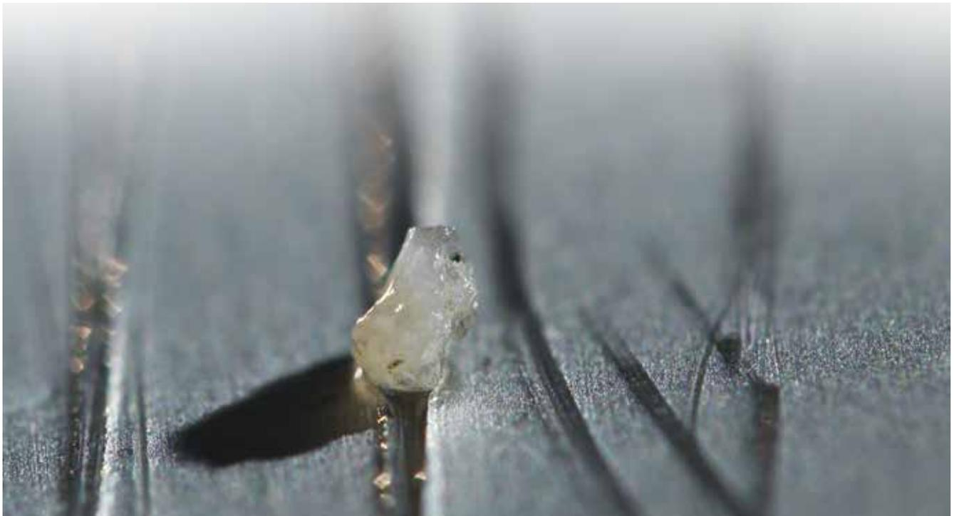
図10. 触媒粒子による損傷の拡大図
