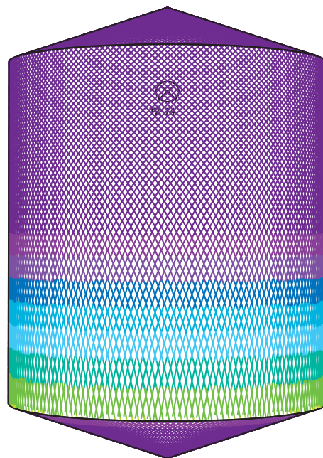
D5m H6m、Toftejorg TZ-74 醸造ケトルバージョン、4 x ø6 mm、100% Time = 18.2 分、水消費量 = 3760 l
