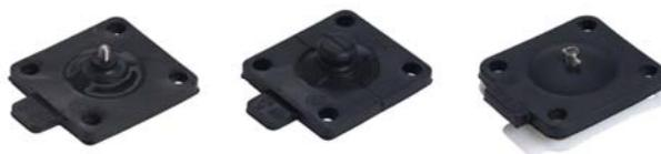
Мембраны доступны как из мягкого эластомера (ЭПДК), так и из жесткого эластомера (ПТФЭ/ЭПДК и модифицированный ПТФЭ/ЭПДК). Твердые эластомеры дополняются мягким эластомером (ЭПДК). Двухкомпонентная конструкция позволяет двум эластомерам работать независимо друг от друга, тем самым снижая напряжение, вызванное различными тепловыми характеристиками.
