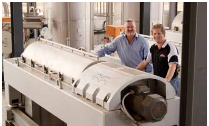
ナマクワは、アルファ・ラバルの4つの大型Foodecデカンタを使用した世界で最も巨大な遠心式デカンタシステムを導入しました。
